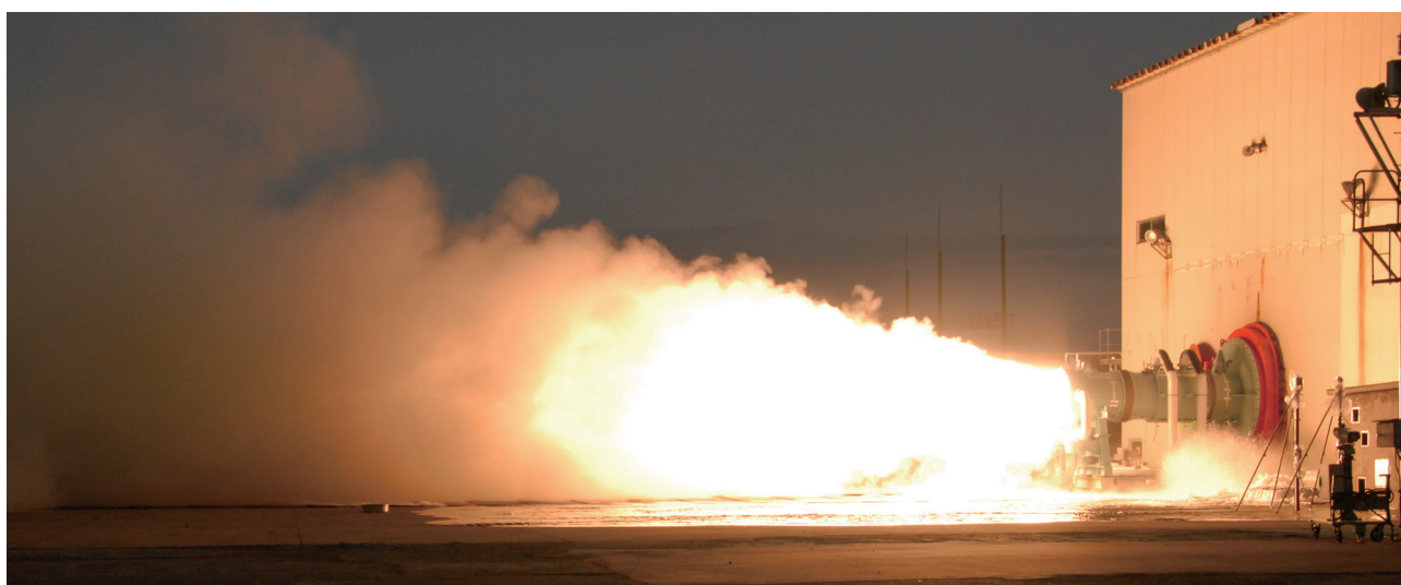
強化型では2段目の新規に開発。画像は2015年12月21日に行った地上燃焼試験の様子
