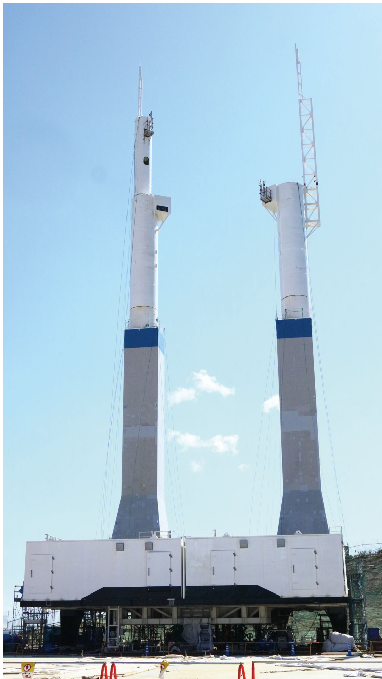
H3 ロケット用新型移動発射台
