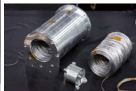
左: 誘導起電力を利用して電流を流し、その電流と地磁場との干渉で発生するローレンツ力で高度を下げるができる 右: 研究中のテザー。微小デブリと衝突しても切断されにくい網状構造になっている
