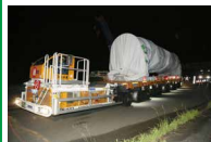
トレーラーに載せて内之浦港から内之浦宇宙空間観測所までの5キロの道のりを時速15キロで移動します
