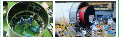
工場からバラバラに到着したロケットはM組立室の中で点検・組立てを行います
