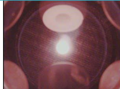
浮遊する溶融酸化アルミニウム
