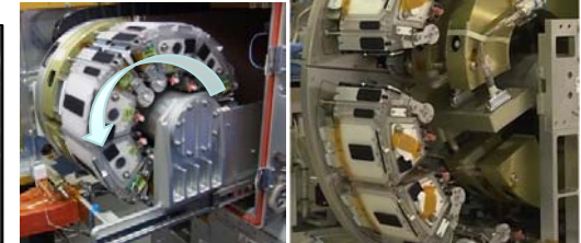
遠心機の回転速度を変えることで、月や火星の低重力を実現可能(左:現行遠心機、右:直径を2.3倍に大型化した新型遠心機)
