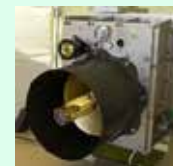
レーザ高度計 LIDAR
