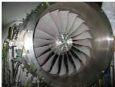
高効率ファン空力性能試験供試体 (回転要素試験設備)
