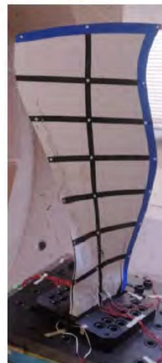
試験後(軽微な損傷のみ)
