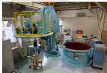
軽量タルディスク耐久性実証試験 (回転強度試験機)
