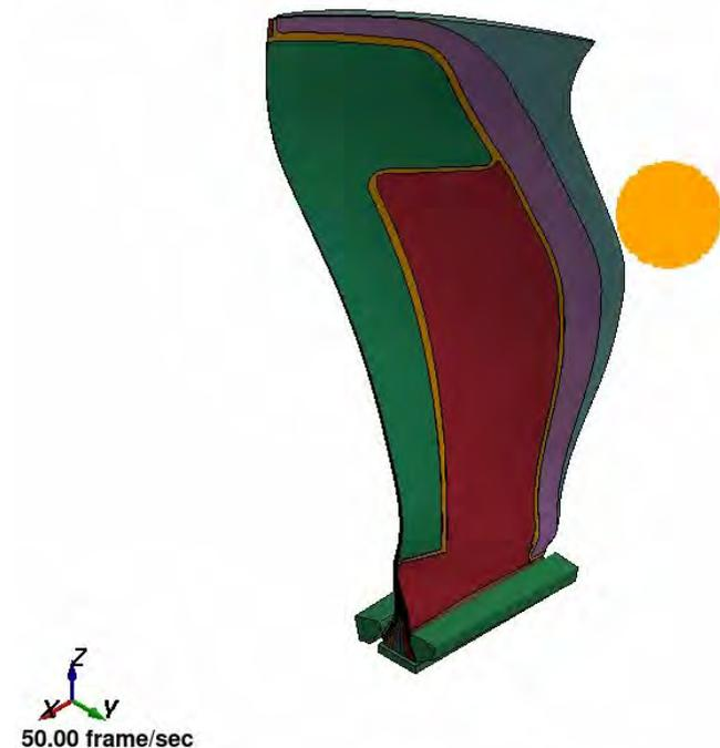
CFRPブレードの高速衝撃解析
