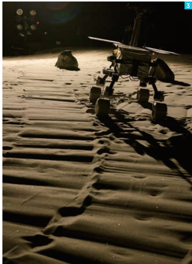
1.JAXA相模原キャンパス内にある、月や惑星の表面地形を模した屋内実験場「宇宙探査フィールド」にて。中山英之さん(左)とJAXA森ハブ長(右)。2.「宇宙探査フィールド」では、実物大の探査機モデルや複数台のローバ／ロボットを持ち込み、表面走行試験や天体着陸を想定した落下実験などを行うことができます。3.足元の砂は、月や火星の砂(レゴリス)を模して作られた実験用の特殊なもの。この砂を使い、平地や斜面といった月惑星の典型的な地形を再現している。
