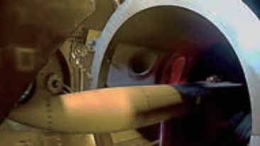
極超音速実験機の燃焼実験(試験設備でマッハ5飛行状態を模擬)
