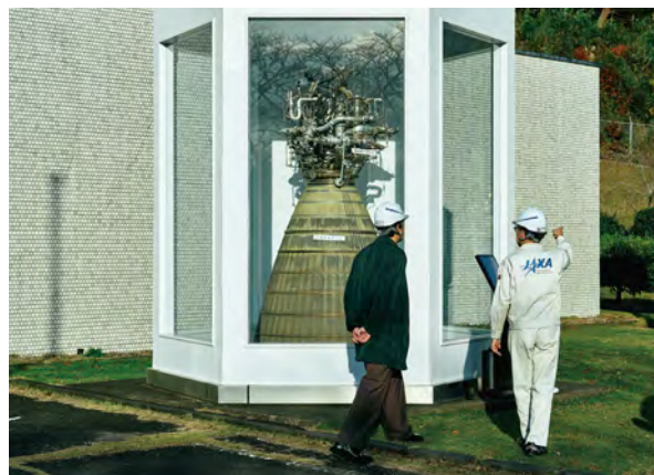
宇宙開発展示室の屋外に展示している大型液体ロケットエンジンは、一般向けに開放されていて自由に見学できる。写真は、LE-5。1975年から国内で開発された、液体酸素と液体水素を推進剤とした実用ロケットエンジン。
