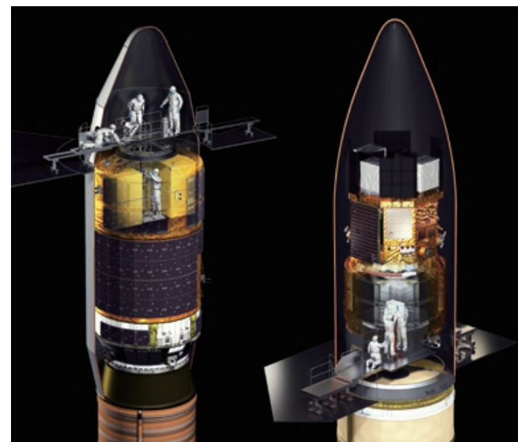
(右)HTV-X、(左)こうのとり(HTV)のフェアリング内レイトアクセスのイメージCG。 下部にレイトアクセスドアを設置したHTV-Xでは打上げ24時間前まで荷物の搭載が可能
