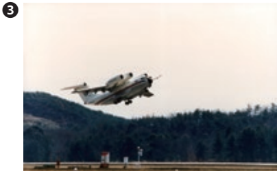
1985年から1989年までの間に、97回の飛行実験を行い短距離離着陸飛行とパワード・リフトSTOL技術の実用化の可能性を実証した「飛鳥」
