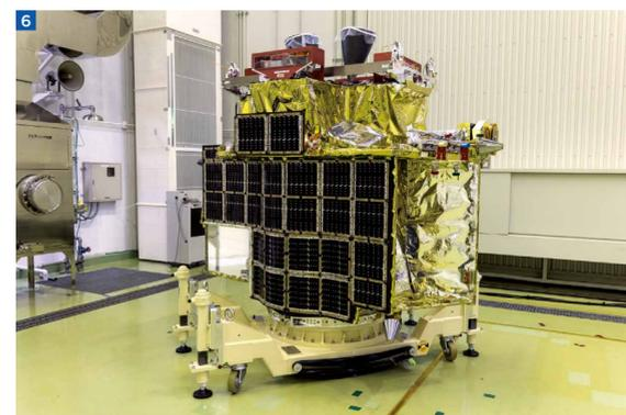
5. 2024年1月20日午前0:20(日本標準時)、SLIMが月面に着陸し、地球との通信を確立。写真は月面着陸後に撮影された搭載航法カメラによる月面の写真。 6. SLIMの実機。写真は種子島宇宙センター内にある衛星フェアリング組立棟(SFA)で、打ち上げを控えている様子。
