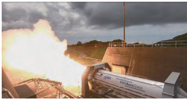
●種子島宇宙センターでの地上燃焼試験。約50年前に建設された試験場は、固体ロケットブースタの開発の歴史を見届けてきた大切な場所。
