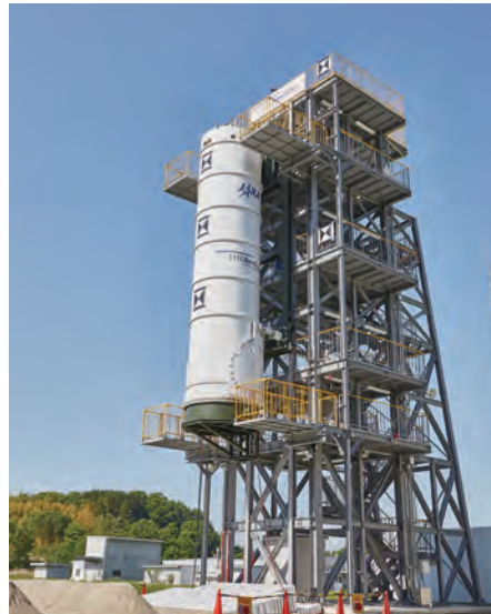
●実機大の供試体を用いた分離試験。「シュー」というガスの音が鳴り、約1秒後、地面に落下する低音が試験場に響いた。
