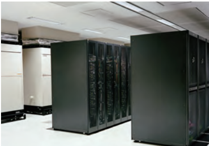
風洞試験を正確にシミュレーションできる、スーパーコンピュータ（スパコン）システム。数値シミュレーションの発展は、スパコンの発達と期を同じくして進められた。
