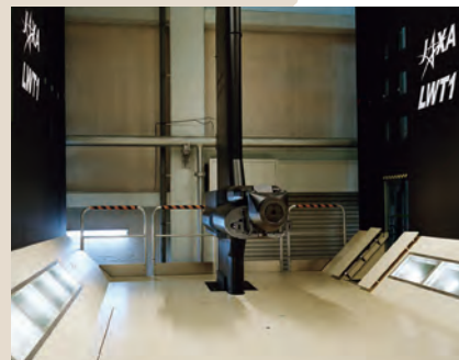
航空機が飛行する状態を模倣するJAXAの試験設備、風洞。装置内に気流を発生させ、実機の100分の1程度の模型に風を当てて、飛行中にどんな空気を受けるのかを把握する。
