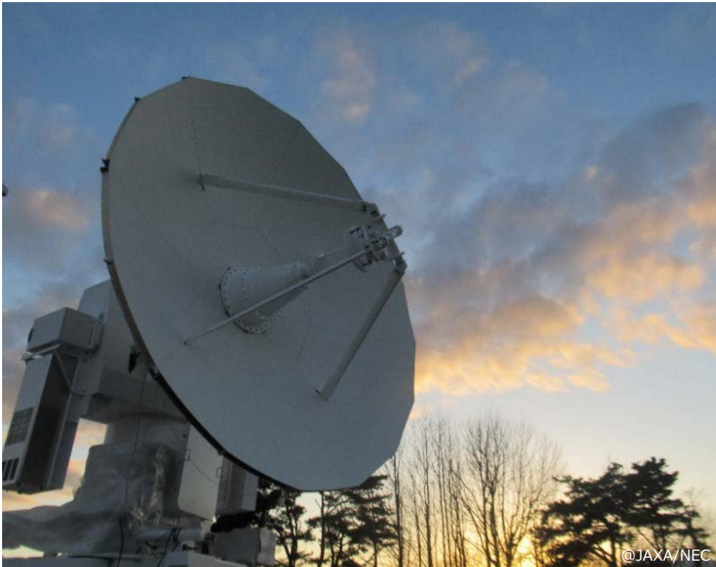
▲開発中のKa帯アンテナ (同じアンテナが埼玉県地球観測センターにも建設される)
