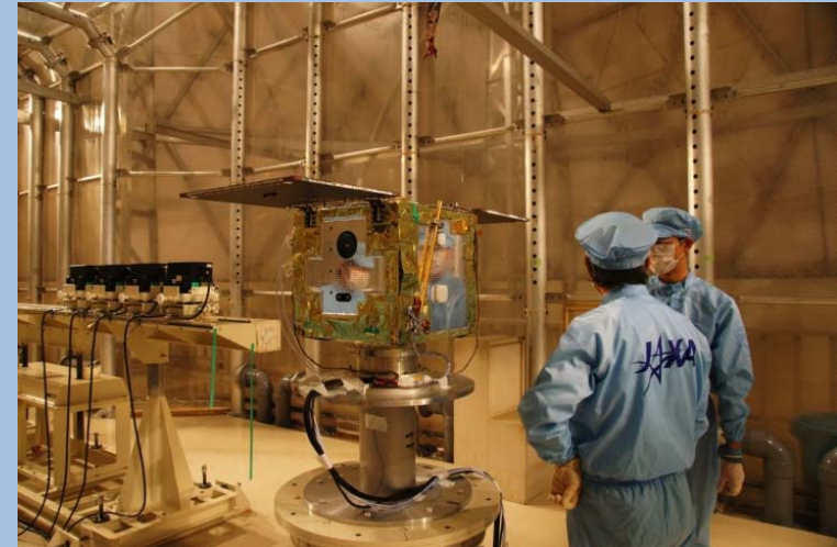
SDS-4 システムレベル磁気モーメント測定
