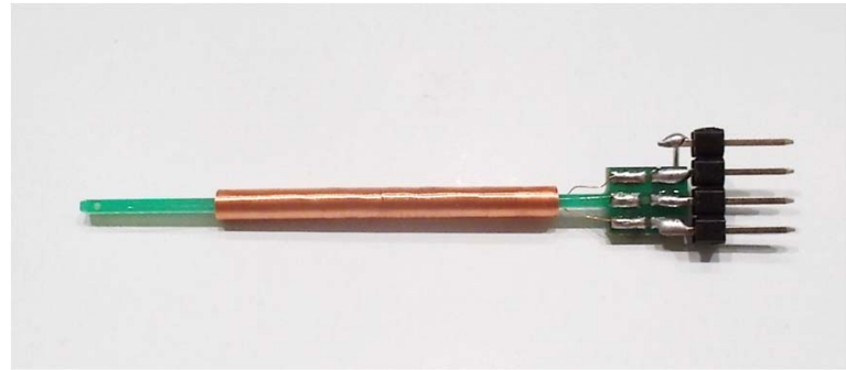
基本波型直交フラックスゲート磁気センサ (九州大学 笹田一郎教授により発明)
