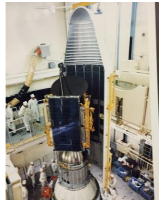
TF#3フェアリング組立作業
