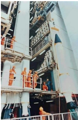
図1 H-I SOB取付け
