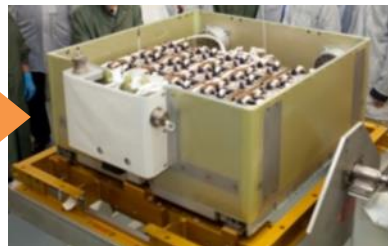
リチウムイオンセルのバッテリーへ組み込み （Aerojet Rocketdyne 社）
