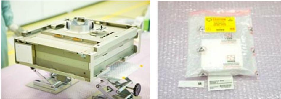
図 5.1.3-3 (左)トルコの材料サンプルを簡易曝露実験装置(ExHAM)に取付けた状態
