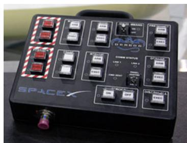
図 A1.6-4 Space X 社のドラゴン用の搭乗員用コマンドパネル (CCP)
