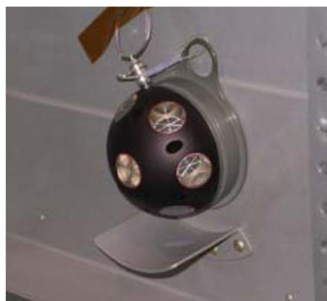
反射器(レーザーダリフレクタ)は、「きぼう」の下部に設置されたレーザー反射鏡です。「このとり」が ISS の下方(地球方向)から接近する際に「このとり」のランデブセンサ(Rendezvous Sensor: RVS)から照射されたレーザー光を反射します。
