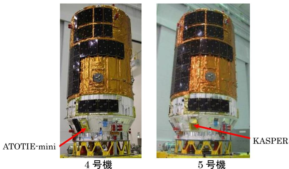
図 6.2-3 参考: 4号機の ATOTIE-mini と 5号機の KASPER の搭載写真 (JAXA)
