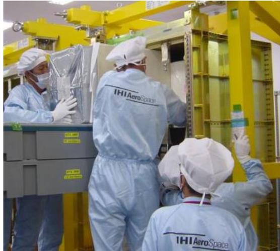
図 5.1-4 HTV 補給ラック(HRR)に搭載される物資輸送用バッグ(CTB)(JAXA)
