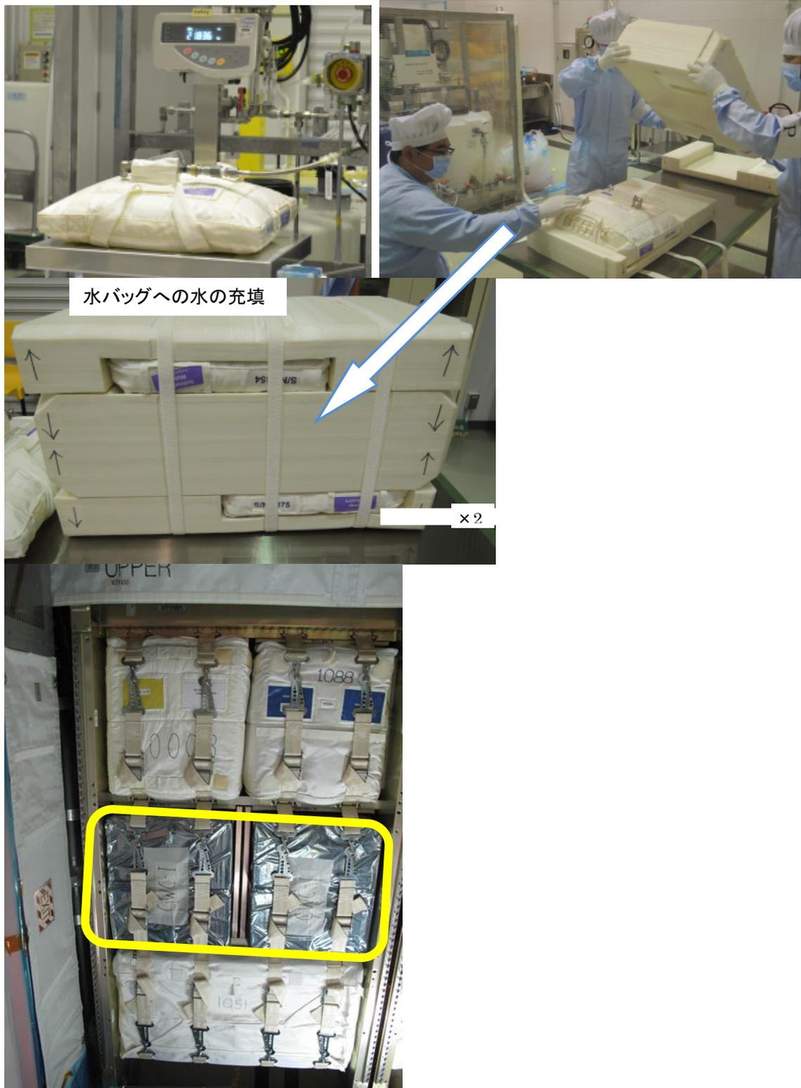
図 A2-2 飲料水を充填した水バッグ(CWC-I)と梱包材(右下:5号機、残りは6号機)(JAXA)
