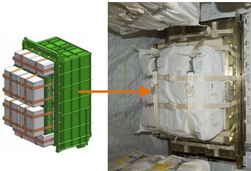
図 5.1-5 ラック前面へ搭載された物資輸送用バッグ(CTB)の例 (2号機)(JAXA)
