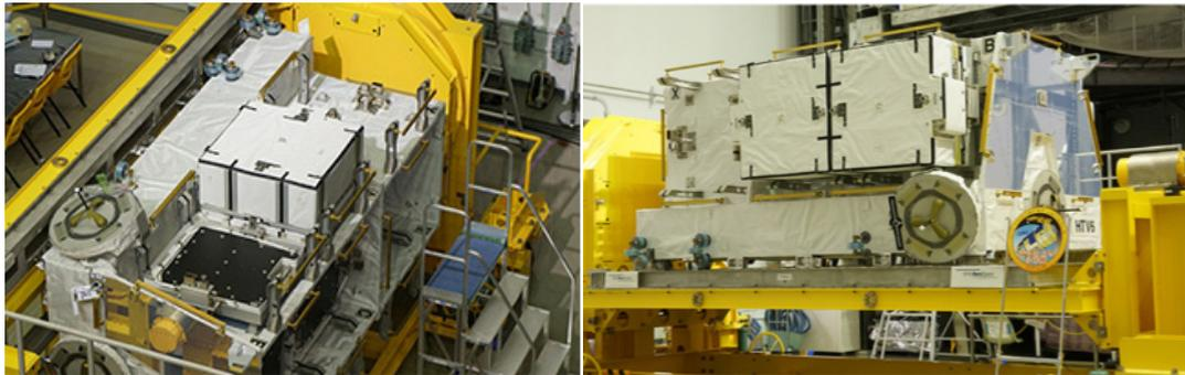
図2-4（左）ISS用バッテリーが1台搭載された状態の曝露パレット
