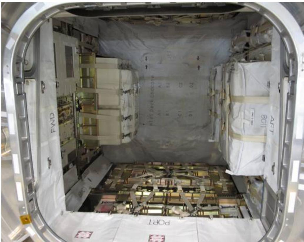
図 5-1 通常搭載完了時(レイトアクセス前)の「こうのとりの」5号機船内の様子 (JAXA)
