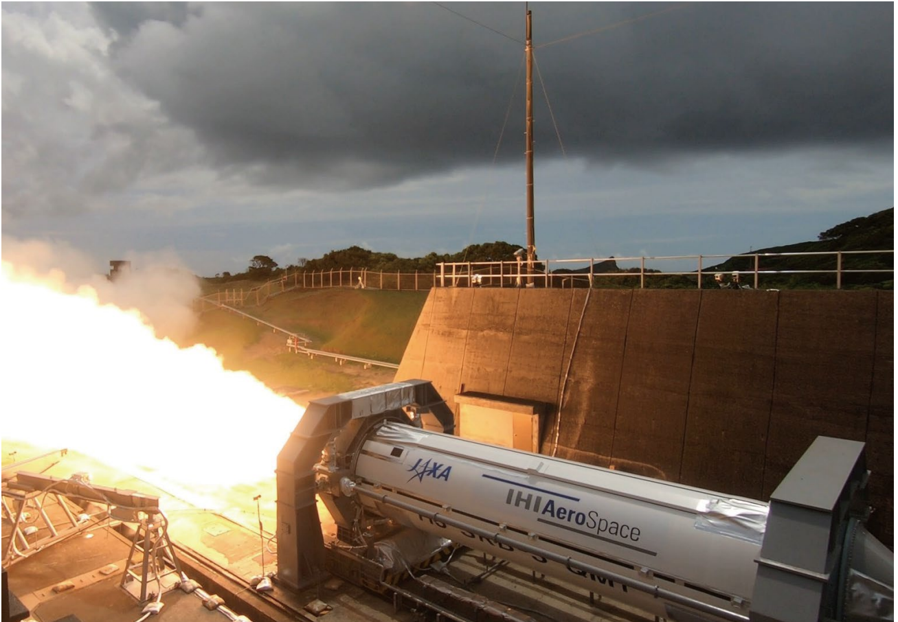
2019年8月21日に実施した、H3 ロケット用固体ロケットブースタ（SRB-3）認定型モータの地上燃焼試験の様子
