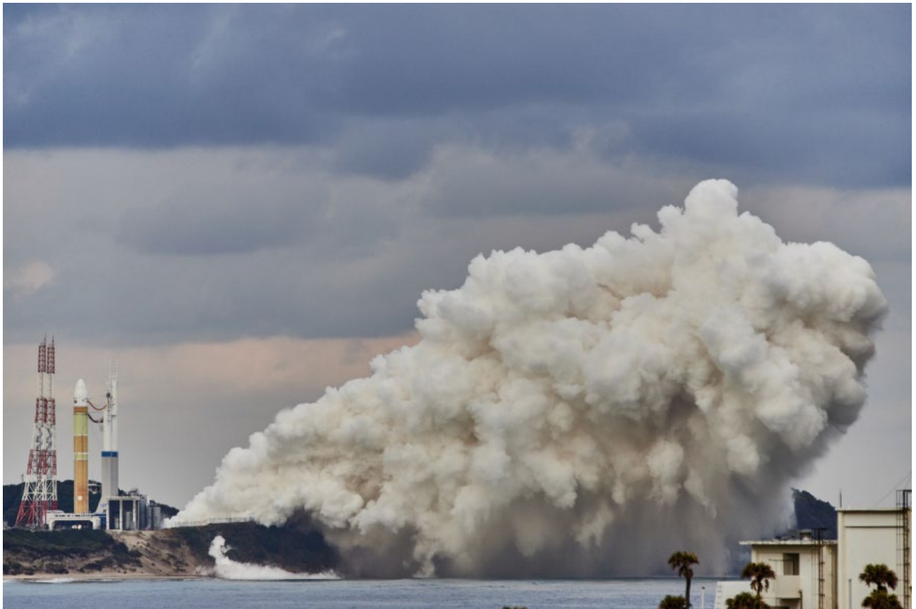
試験機 1 号機の 1 段実機型タンクステージ燃焼試験（CFT）の様子
