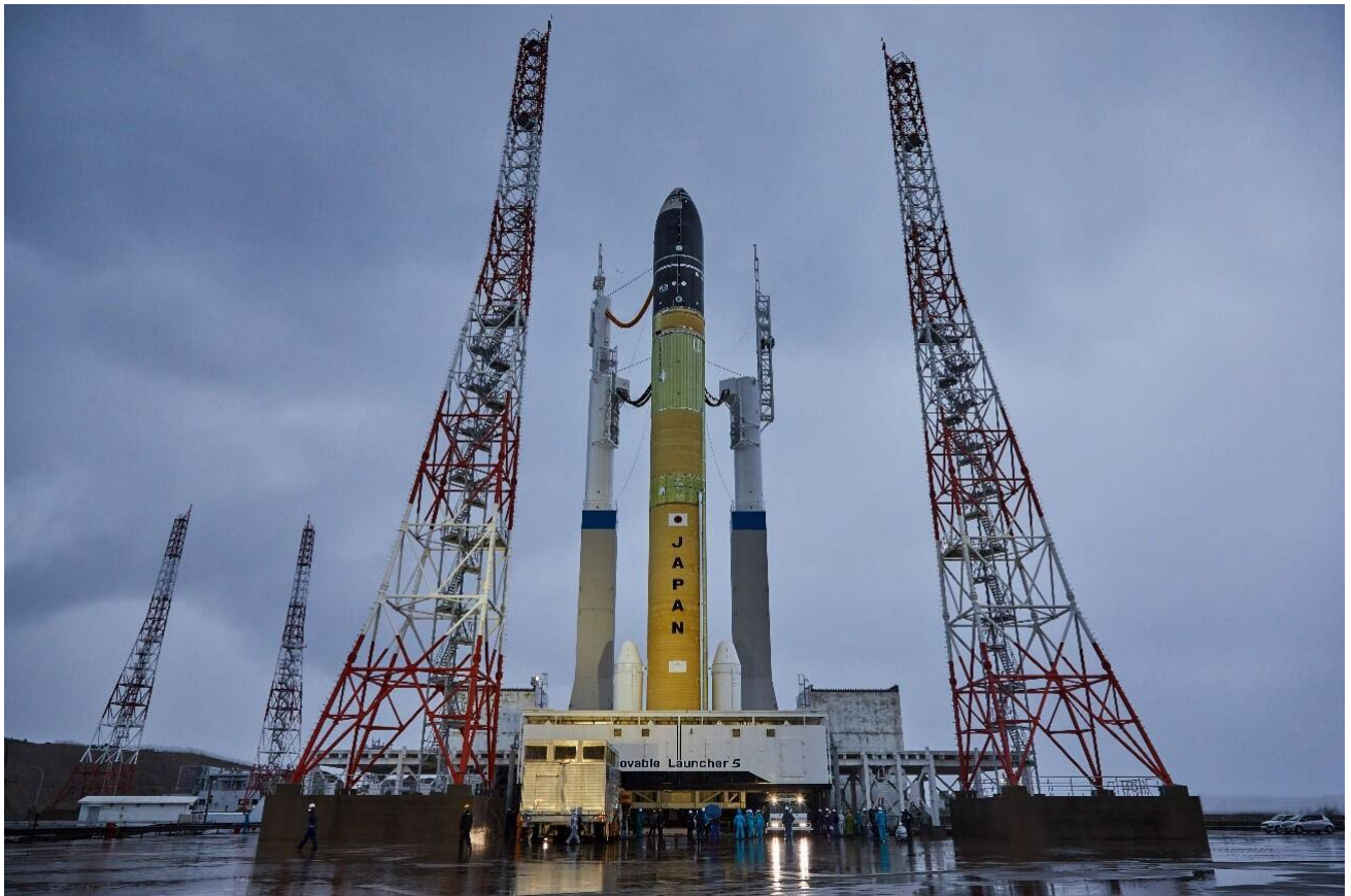
H3 ロケット試験機 1 号機の極低温点検の様子
