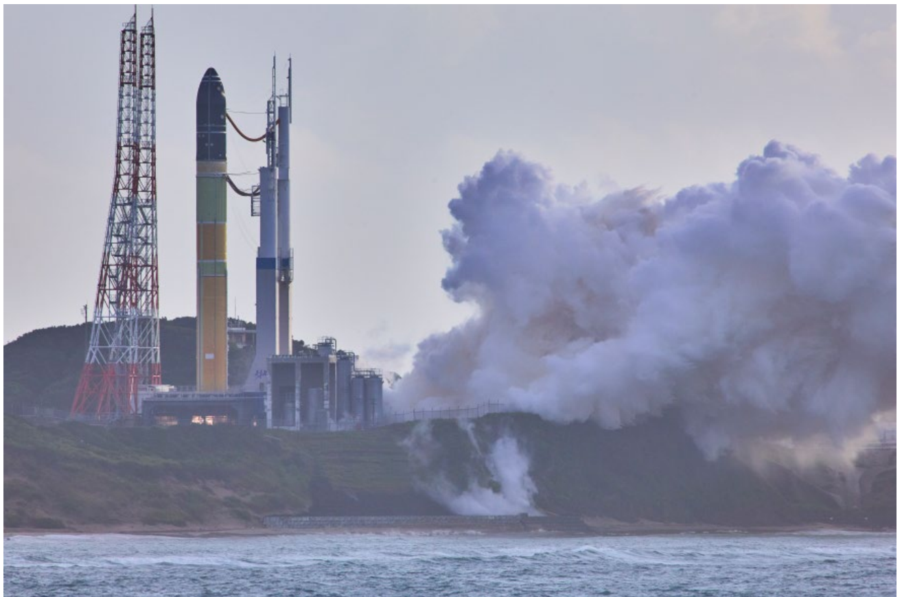
H3 ロケット 6 号機（30 形態試験機）1 段実機型タンクステージ燃焼試験
