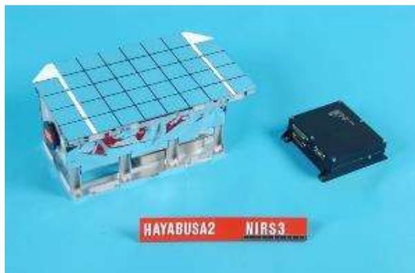
3 $\mu\text{m}$ 帯を含む赤外線スペクトル:小惑星表面の鉱物の分布を調べる
