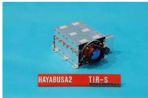
8~12 $\mu\text{m}$ での撮像:小惑星表面温度を調べる
