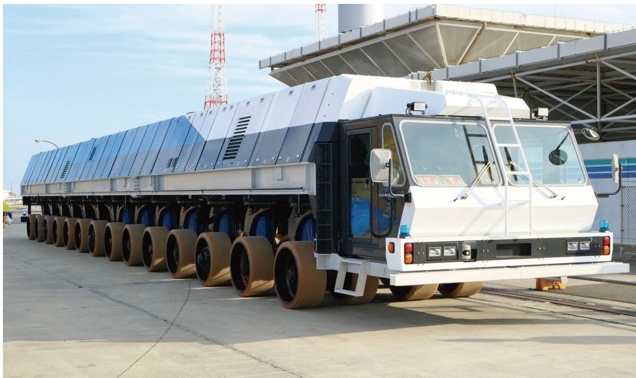
H3 ロケット用新型移動発射台運搬台車（ドーリー）
