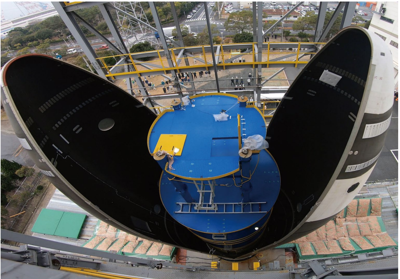
2019年12月17日に実施した、H3 ロケット用フェアリング分離放てき試験の様子
