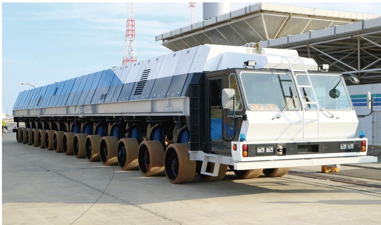
H3ロケット用新型移動発射台運搬台車（ドーリー）
