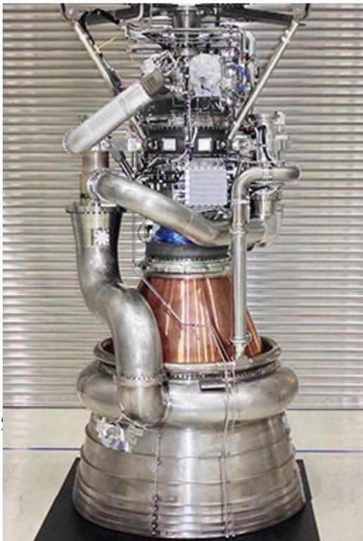
LE-9は、エクスパンダー・ブリード・サイクルと呼ばれる日本独自のロケットエンジン技術を、初めて第1段向けの大推力エンジンとして採用する。
