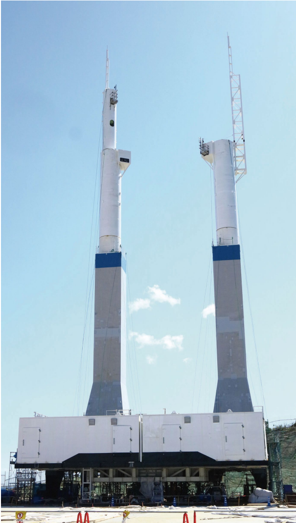
H3 ロケット用新型移動発射台
