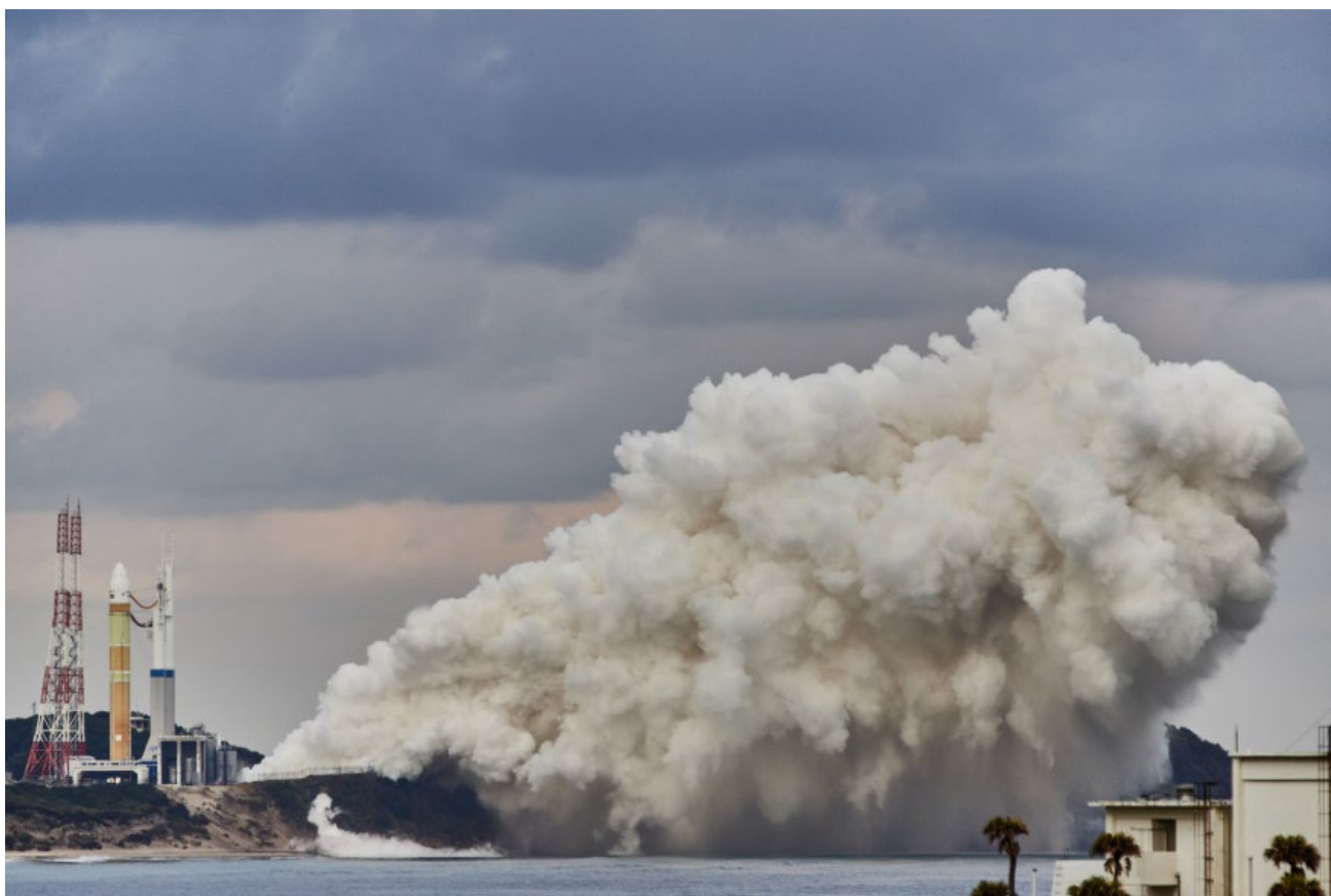
11月6日から8日にかけて行った、1段実機型タンクステージ燃焼試験（CFT）の様子
