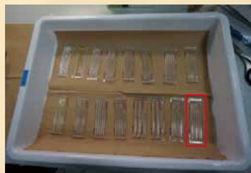
実験後、地球に戻ってきたタンパク質の容器 (赤枠の大きさ 縦約10cm×横約3cm)。
