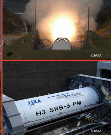
左、右上は種子島宇宙センター竹崎固体ロケット試験場にて実施されたSRB-3の燃焼試験の様子。右下は試験場に据えられたSRB-3のプロトタイプモデル外観。この燃焼試験の記録映像が「ファン!ファン!JAXA」サイトでご覧いただけます。
