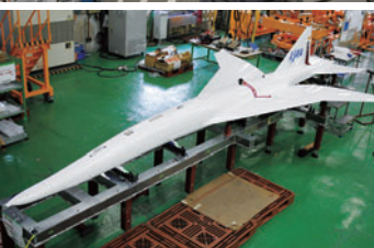
上:「きぼう」日本実験棟を効果的に活用し、より多くの利用と技術の成果を生み出す。下:超音速試験機を落下させ「低ソニックブーム設計概念」を飛行実証するD-SENDプロジェクト第2フェーズ試験を2013年夏に予定。画像はD-SEND#2実機
