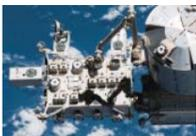
取り付けられた船外実験プラットフォーム。これにより、軌道上での「きぼう」の組み立てが完了した
