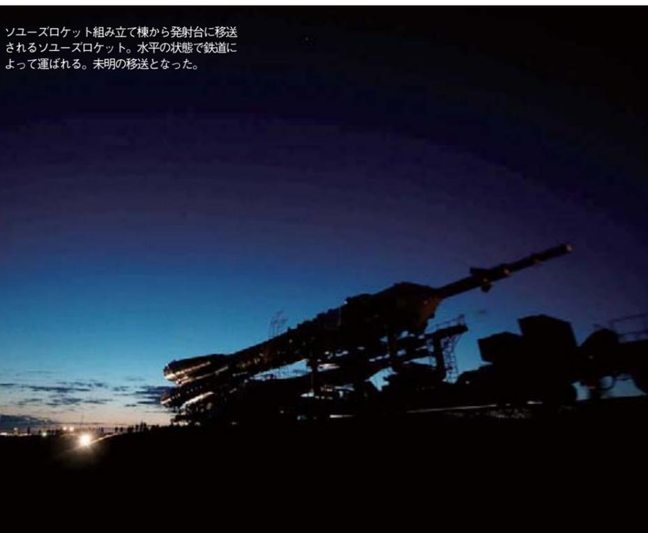
ソユーズロケット組み立て棟から発射台に移送されるソユーズロケット。水平の状態を鉄道によって運ばれる。未明の移送となった。
