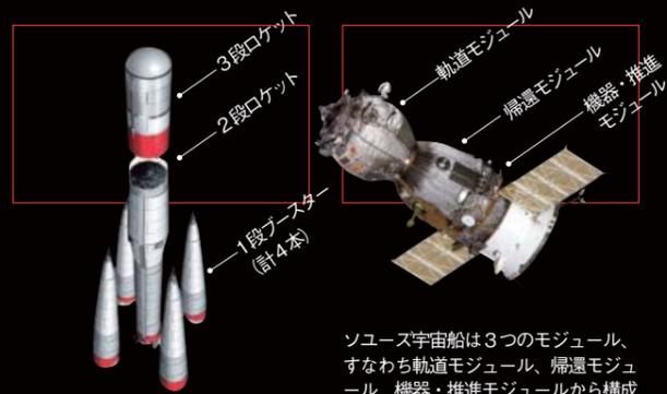
上/ソユーズロケットは3段式で、第1段は円錐形のブースター4基から構成されている。これらのブースターは第2段ロケットの周囲に取り付けられている。第1段と第2段は打ち上げ時に同時に点火される。第1段の燃焼時間は118秒間、第2段は290秒間、第1段を分離した後も、第2段で上昇する。第2段を切り離した後、第3段に点火する。（イラストは、Starsem社のSoyuzユーザーズマニュアルより）
