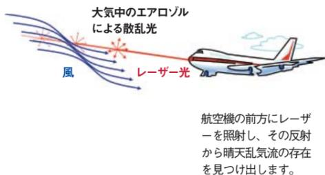
航空機の前方にレーザーを照射し、その反射から晴天乱気流の存在を見つけ出します。
