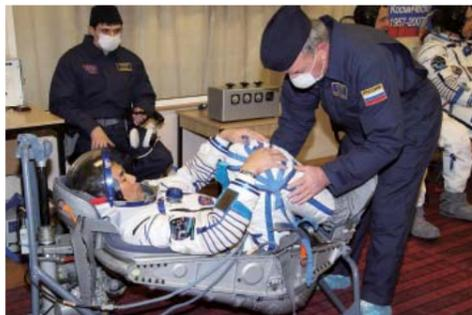
ソコルと圧服のチェックを行う野口宇宙飛行士。打ち上げ時と帰還時には与圧服を着用し、このような姿勢で座席に着く。座席の頭部下には衝撃を吸収するためのダンパーがある。また、各宇宙飛行士の体型に合わせた専用のシートライナーがつくれ、座席に取り付けられる。これも衝撃を吸収するためである。
