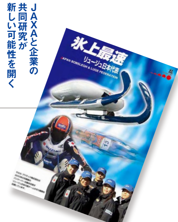
リュージュ連盟ポスター 宇宙航空分野で得られた技術を、氷上最速のスポーツ分野へ。新しい炭素繊維強化プラスチックは、リュージュのソリの胴体部分に採用される。
