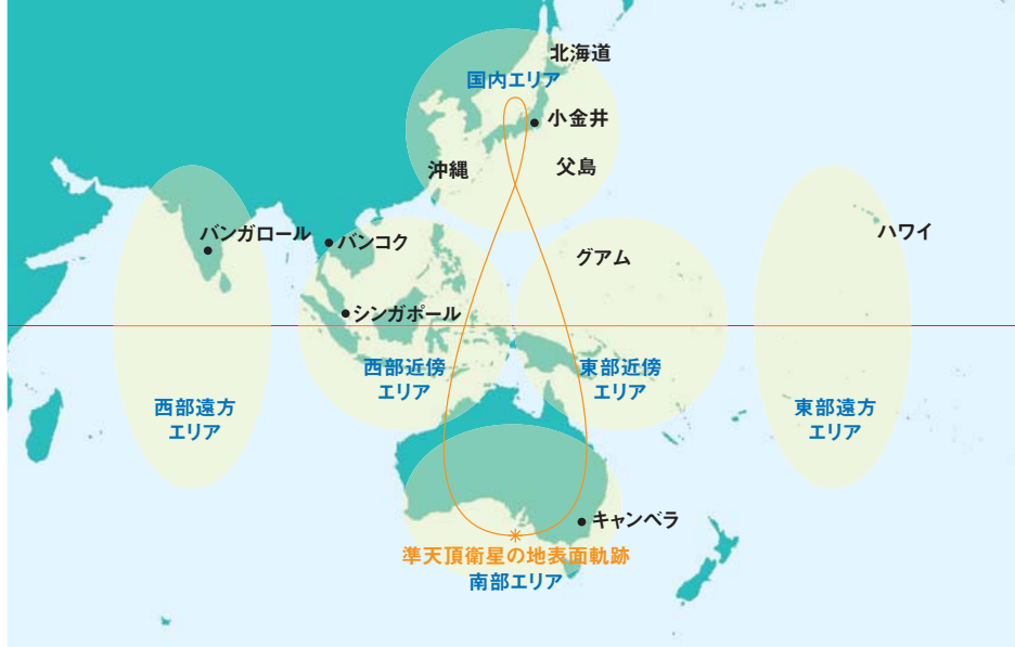
衛星が地上に描く軌跡は8の字型。各国と連携して衛星の位置情報をモニターする計画
