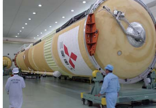
6月末、三菱重工業 名古屋航空宇宙システム製作所で公開されたH-IIAロケット13号機の第1段機体。
