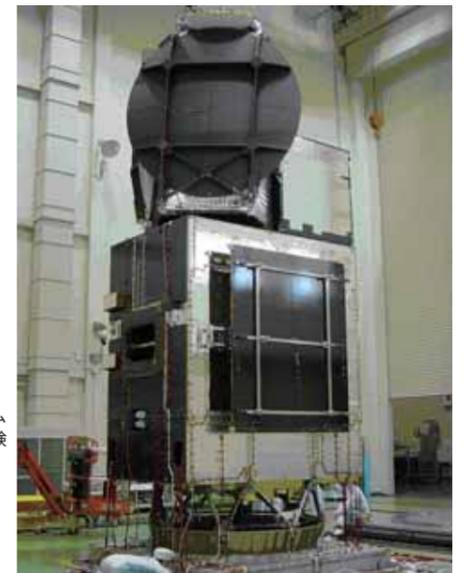
総合環境試験棟での「WINDS」システム熱構造モデル正弦波振動試験
