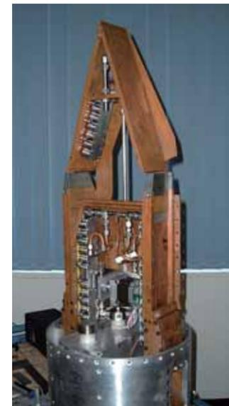
ロケット先端に搭載するスクラムジェット燃焼器
