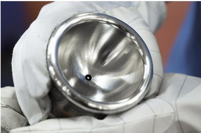
写真上：手にしているのは電子銃。中央の穴から電子ビームが発射される。
