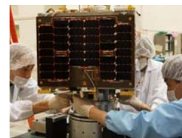
RISERAT 質量特性試験
