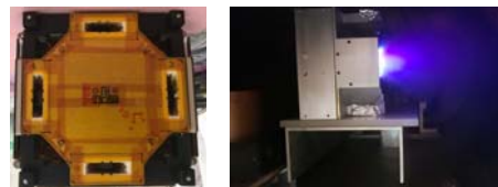
PPT噴射口(左)と実験室でのPPTの噴射時の様子(右)
