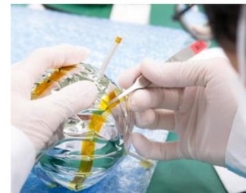
2枚のフィルムでくるんだ後、野球のボールの縫い目と同じような位置をテープで貼り合わせていきます。
