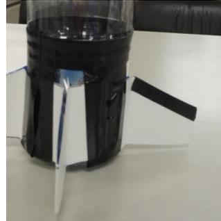
（フィン（翼）は90度おき等間隔に、ノーズコーン（先端）は機体の中心になるように取り付けて下さい。写真（左、中央）の様に、真上から見ると、取り付け状況の確認が行えます。
