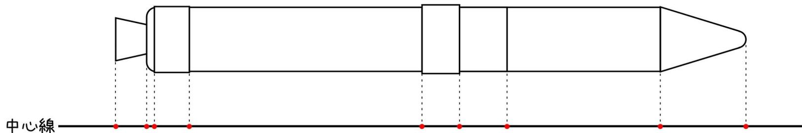
中心線となる線をテープで引いて、設計図に従って、ロケットの横線に当たる部分に印をつけていきます。
