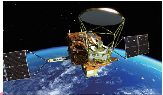
地球規模の水循環の変動を長期間にわたって観測する「しずく」。高性能のマイクロ波放射計(AMSR2)により、海面温度や降水量、水蒸気量、土壌水分量など、地球全体の水のめぐりを見つめます。「しずく」はH-IIAロケット21号機で2012年5月18日午前1時39分ごろに、種子島宇宙センターから打ち上げられる予定です。また、相乗り衛星として小型実証衛星4型「SDS-4」が搭載されます。打ち上げに向けて特設サイトがオープンしましたので、ぜひご覧ください。皆様の応援よろしくお願いたします。
