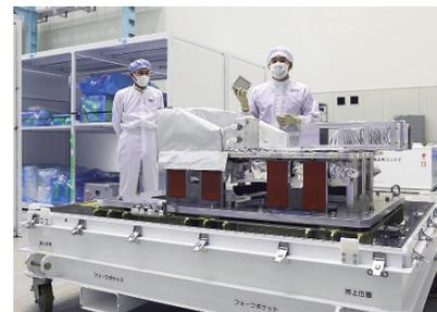
上:プレス公開された小型衛星放出機構。長期滞在中に、小型衛星を「きぼう」エアロックから周回軌道に打ち出す実験を実施する
