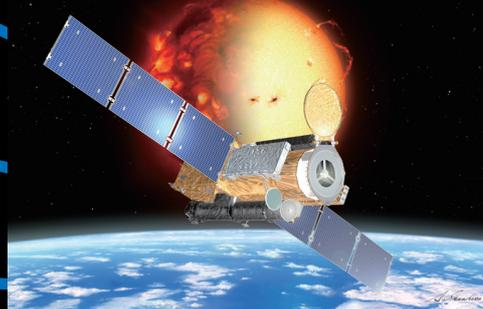
太陽同期軌道を回る「ひので」。可視光、X線、極紫外線の3種類の望遠鏡を搭載し、太陽コロナで起こる活動現象の謎とメカニズムの解明に活躍している
